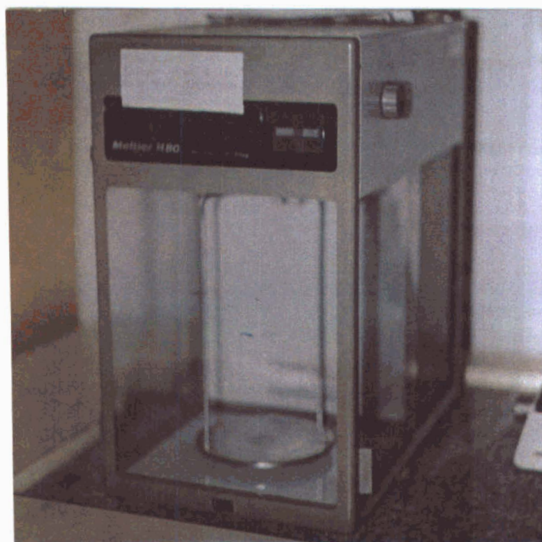
Foto 4: Balanza de precisión Mettler H80, con precisión de 0,1 mg hasta 160 g, utilizada para pesar las fracciones densas y magnéticas.
