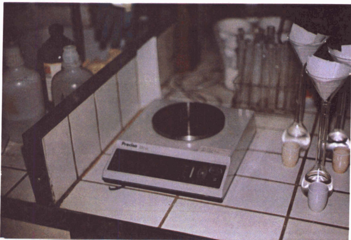
Foto 2: Balanza Precisa 220 M , con precisión de 0,01 g hasta 225 g, utilizada para pesar las fracciones de distintos tamaños.
